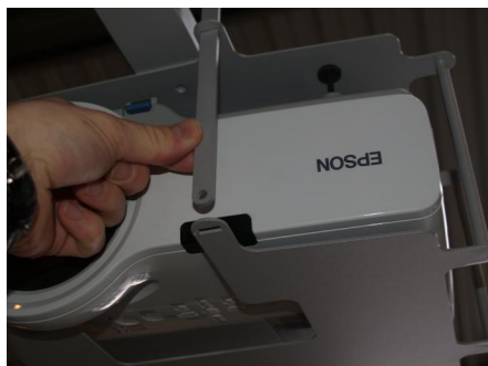
Tyverisikring på projektorhus
